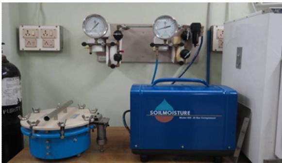
**Pressure Plate Apparatus**
